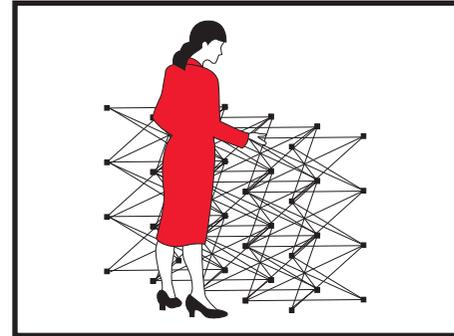
Saisir deux rotules centrales et ouvrir la structure en la soulevant à hauteur d'épaules. Manipuler la structure par les rotules.
