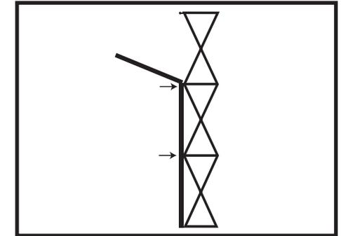
Encliqueter les deux éléments de raccordement suivants sur les structures.
