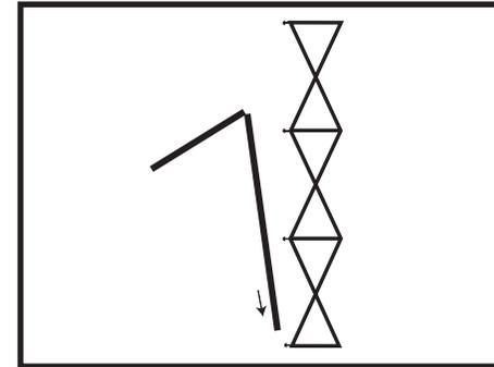
Insérer la partie inférieure des crémaillères dans les taquets situés à la base des structures.
