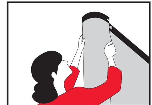
Recourber le coffrage et soulever et poser sur les taquets situés au sommet des deux côtés de la structure. Pour les panneaux à charnière, accrochez un côté, puis l'autre. Appliquer graduellement vers le bas le long des aimants.
