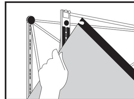
Suspendre d'abord tous les panneaux supérieurs et les bandes entières. Soulever et poser sur les taquets situés au sommet de la structure. Accrocher d'abord un côté, puis l'autre. Appliquer graduellement vers le bas le long des aimants.
