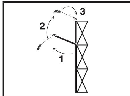
Faire pivoter la partie supérieure de la crémaillère en la levant et l'insérer sur le taquet.
